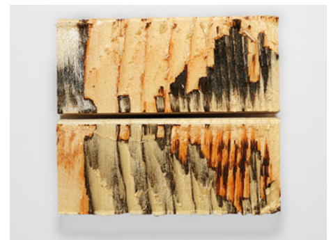
Abb. 10: Bruchflächen nach Scherprüfung
