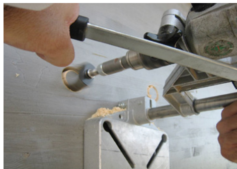
Abb. 2: Führung des Zapfenbohrers / Scheibenschneiders mit einem Bohrständler
